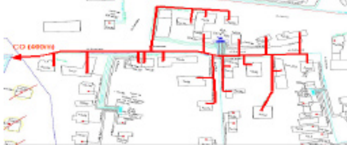
Obr. 4. Schéma přípojek FTTH mikrotrubičkovou technologií
